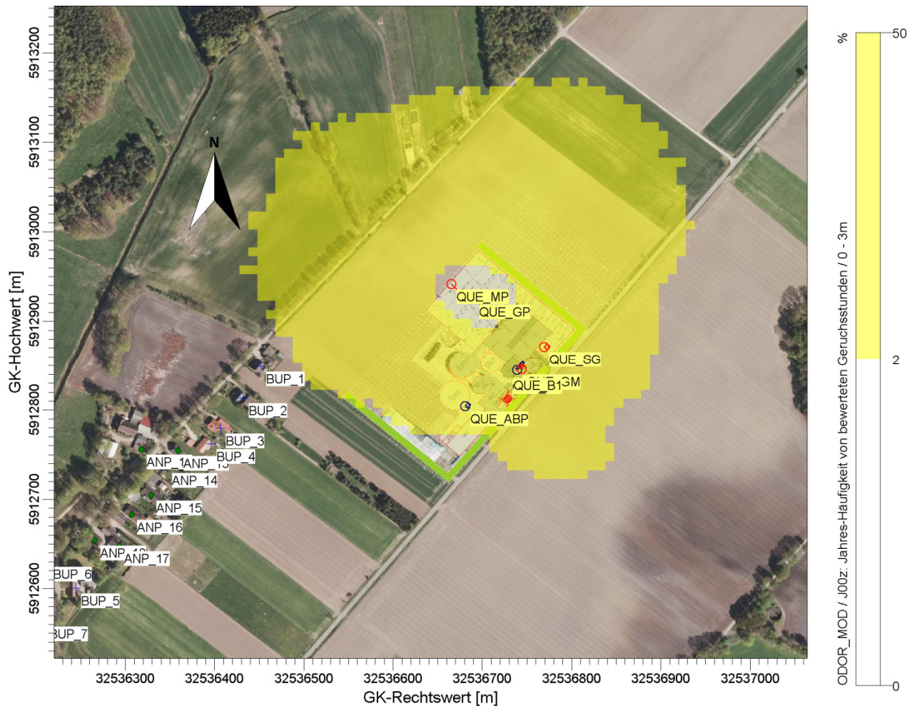
Abbildung 1: Geruchsimmissionen durch die Biogasanlage Behrens alleine, Belastung über und unter 2 % der Jahresstunden (angegeben als Überschreitungshäufigkeiten der Geruchsschwelle)
