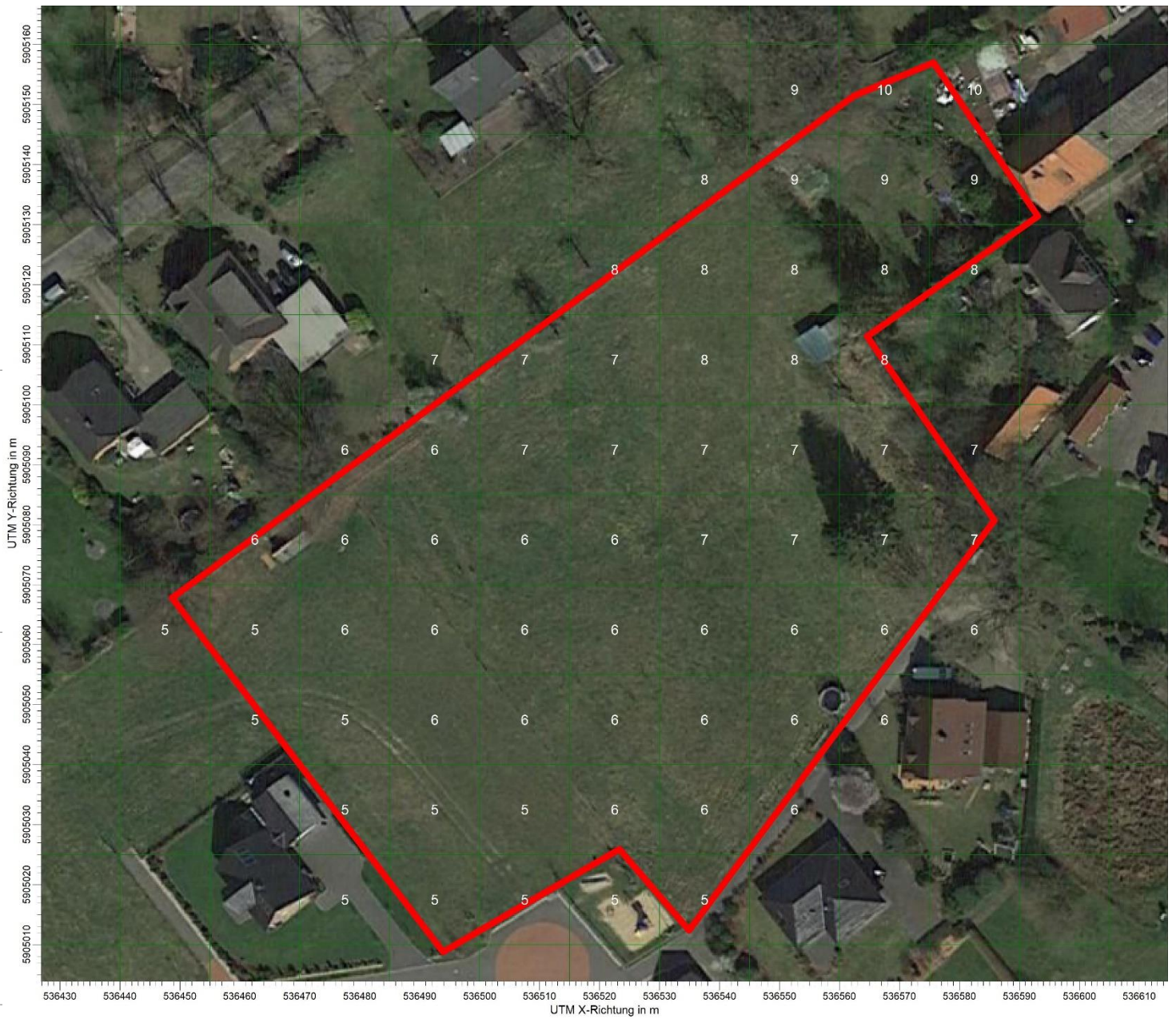
Abbildung 1: Kenngrößen der Geruchbelastung ohne die Berücksichtigung des Stalles Q5.1 als belästigungsrelevante Überschreitungshäufigkeiten der Geruchsschwelle
